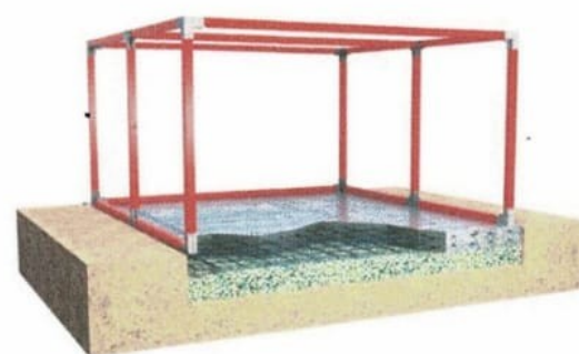
Losa de cimentación
