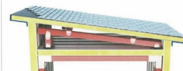
Cubierta a un agua acabado pizarra
