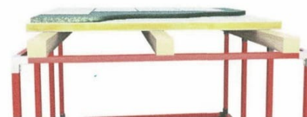
Forjado intermedio vigas de madera laminada
